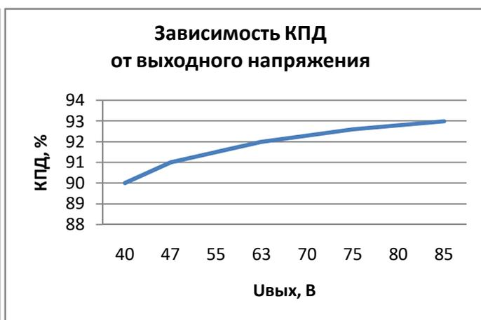
Все параметры измерены при напряжении питания 220В АС и номинальной нагрузке при 25°C окружающей среды.
